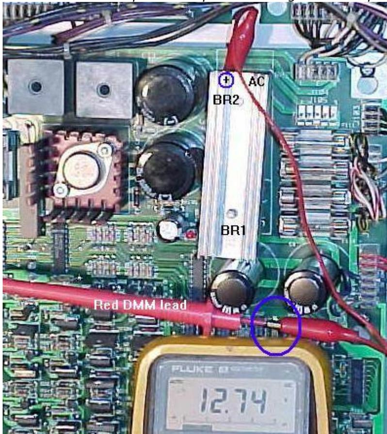
6. Apaga la máquina. Coge el segundo puente de prueba, y engancha un extremo al LADO BANDA de un diodo de 6 Amperios.
