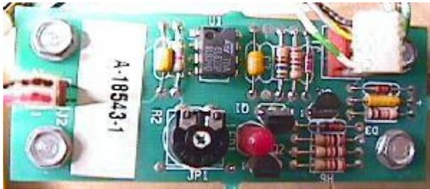
A menudo los sensores eddy se desajustan y pierden sensibilidad, como consecuencia pueden fallar y no activarse cuando la bola pasa por encima de ellos en el tablero. Ajustar un sensor eddy es bastante sencillo, basta con hacer lo siguiente:
