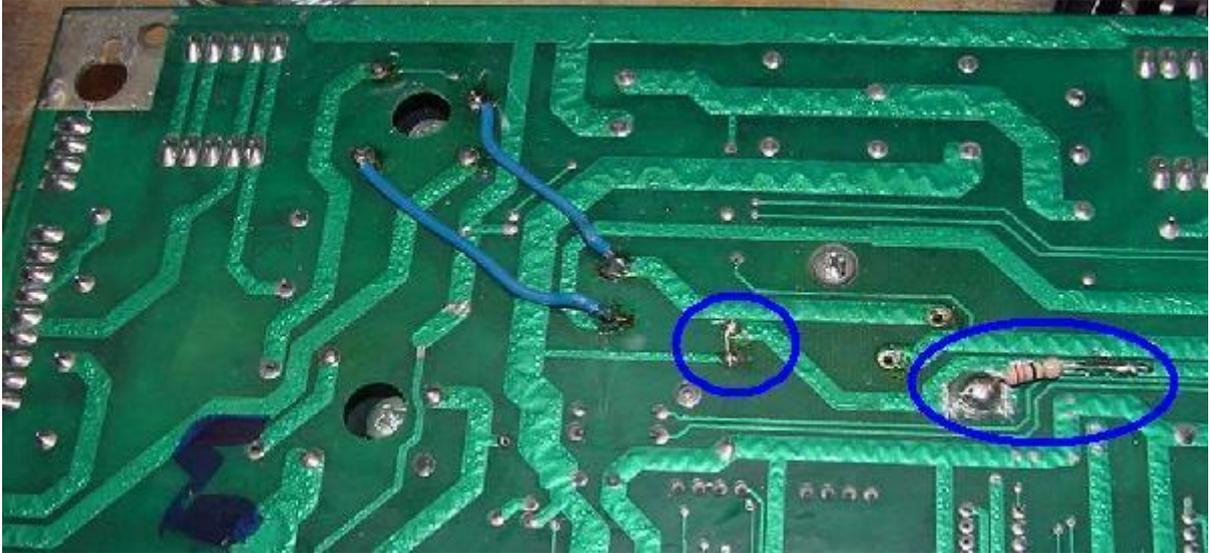
Lado de componentes de la placa controladora con el regulador de voltaje LM323k extraído. La línea azul muestra donde se cortó la pista para aislar de masa al encapsulado metálico del LM323K. Esto sólo es necesario en algunas versiones de la placa controladora.
