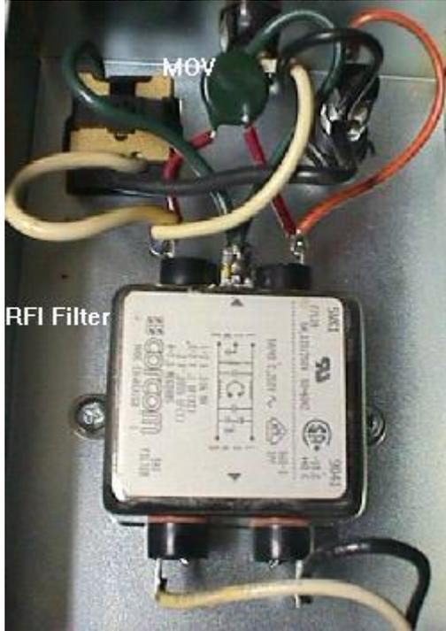
El MOV (metal oxide varistor) (varistor de metal óxido) está diseñado para tener gran resistencia. Pero cuando el voltaje pasa de lo permitido, internamente se cortocircuita. Esto funde el fusible de línea inmediatamente y la máquina deja de recibir alimentación, salvando todo menos el fusible y el propio MOV. Pequeñas sobretensiones y picos pueden ser absorbidos por el MOV sin estropearse pero si son muchas el MOV acabara fundiéndose.
