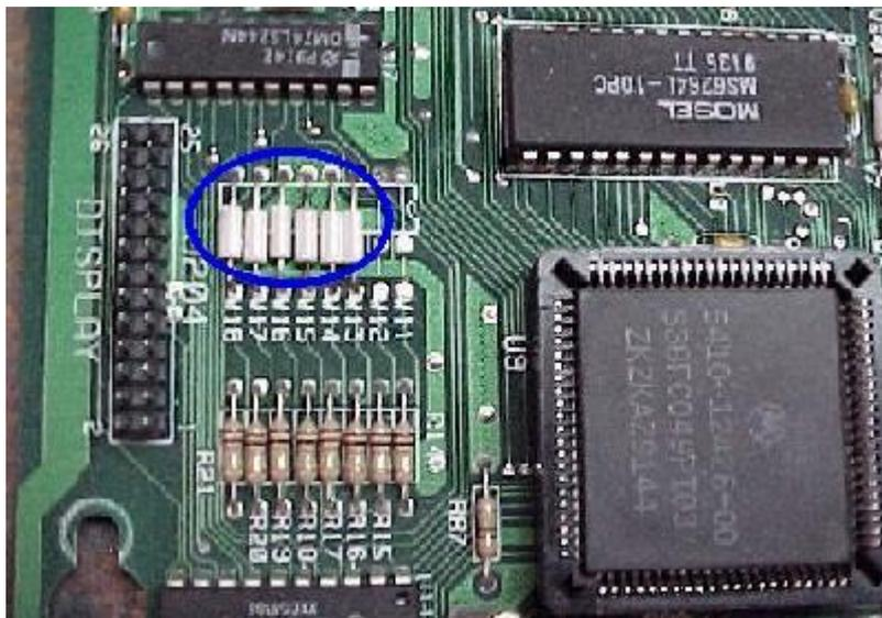
En el WPC-S y WPC-95, Williams empezó a montar un bloque de interruptores DIP de ocho posiciones para el ajuste de país por defecto. Esto facilita enormemente el cambiar este ajuste que ya no necesita de herramientas. Esta es una tabla con los ajustes típicos (como siempre consulta el manual para comprobar los ajustes correctos para tu máquina):
