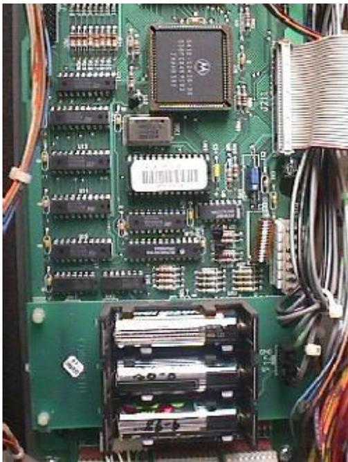
*Una tarjeta CPU "WPC-Security". El chip con el código de barras es el PIC de seguridad. Este chip es específico de cada juego. Se pueden conseguir recambios en [www.shiftedbit.com](http://www.shiftedbit.com). Observa la colocación de las baterías en estas tarjetas que varía respecto a la generación anterior.*
