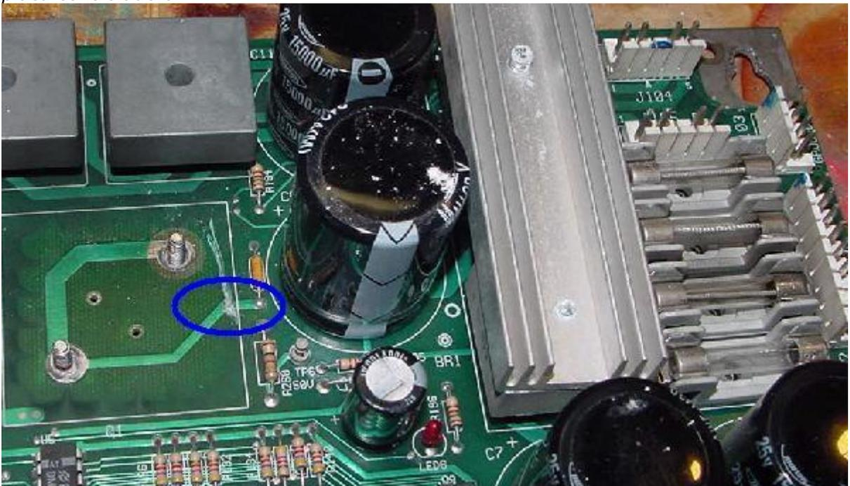
También puede realizarse una modificación similar en una placa controladora WPC-95. En este caso el regulador de 5 voltios es un LM317, que es un regulador de voltaje de salida variable. Williams ajustó el voltaje a 5 voltios usando una resistencia de 750 ohmios 1/2 vatio en R1. Si
