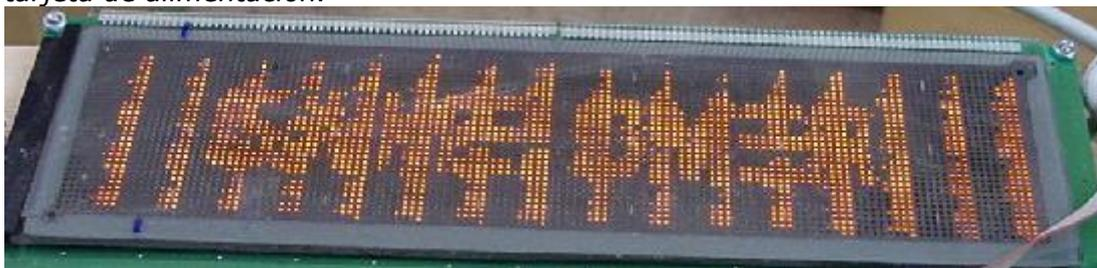
*Otro ejemplo de pantalla con basura que fue arreglado reconectando el cable entre la CPU y la tarjeta de alimentación (gracias a Wil por la imagen).*
