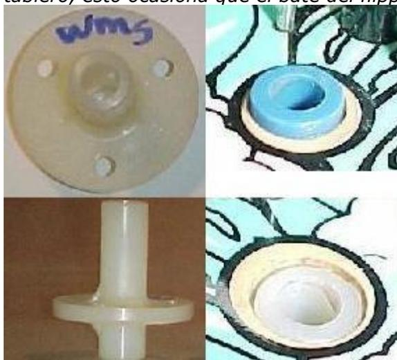
Para cambiar el cojinete del flipper, hay que desmontar la base sobre la que va montado todo el conjunto. Esto permite acceder a los tres tornillos de 6-32 x 3/8" con tuercas que sujetan el cojinete a la base. Las tuercas van montadas en la parte inferior de la base por lo que son inaccesibles al menos que se desmonte la base.
