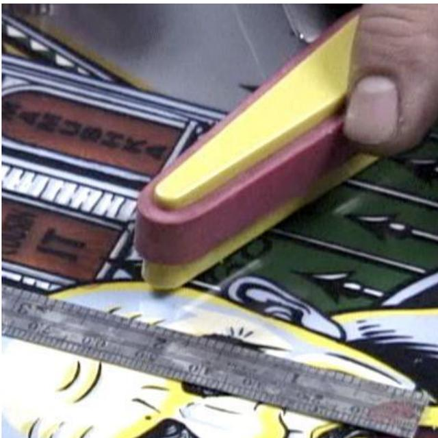
Para corregir un recorrido demasiado corto, utiliza unos alicates de pico de loro para doblar el soporte de la goma de tope de retorno que determina la posición de reposo del flipper. Dobla sólo un poco y vuelve a comprobar la carrera para ver si ya da los 60 mm (2 3/8") de carrera. Observa que la posición de reposo del flipper necesitará volver a ser ajustada después de esto, por tanto hay que volver a repetir los pasos 11 y 12.
