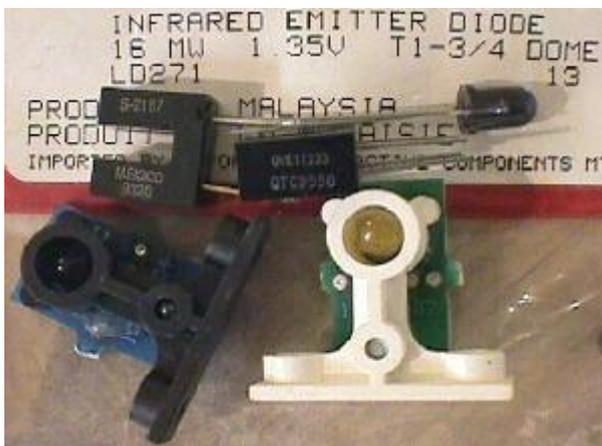
**Izquierda:** Tipo 2 de tarjeta de opto de flipper. Fíjate en la orientación de los optos y en el actuador plástico que entra horizontalmente en la "U". Este estilo de tarjeta se usó en pinballs WPC desde Indiana Jones a Cactus Canyon (con una pequeña revisión con el WPC95, que monta optos en "U" de 5 pines tipo trigger Schmitt).
