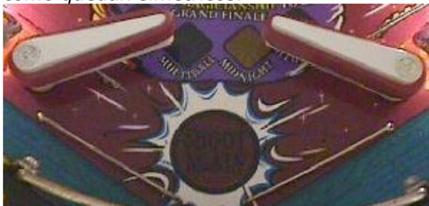
**Paso 12: Comprueba la alineación del flipper en la posición superior.**
