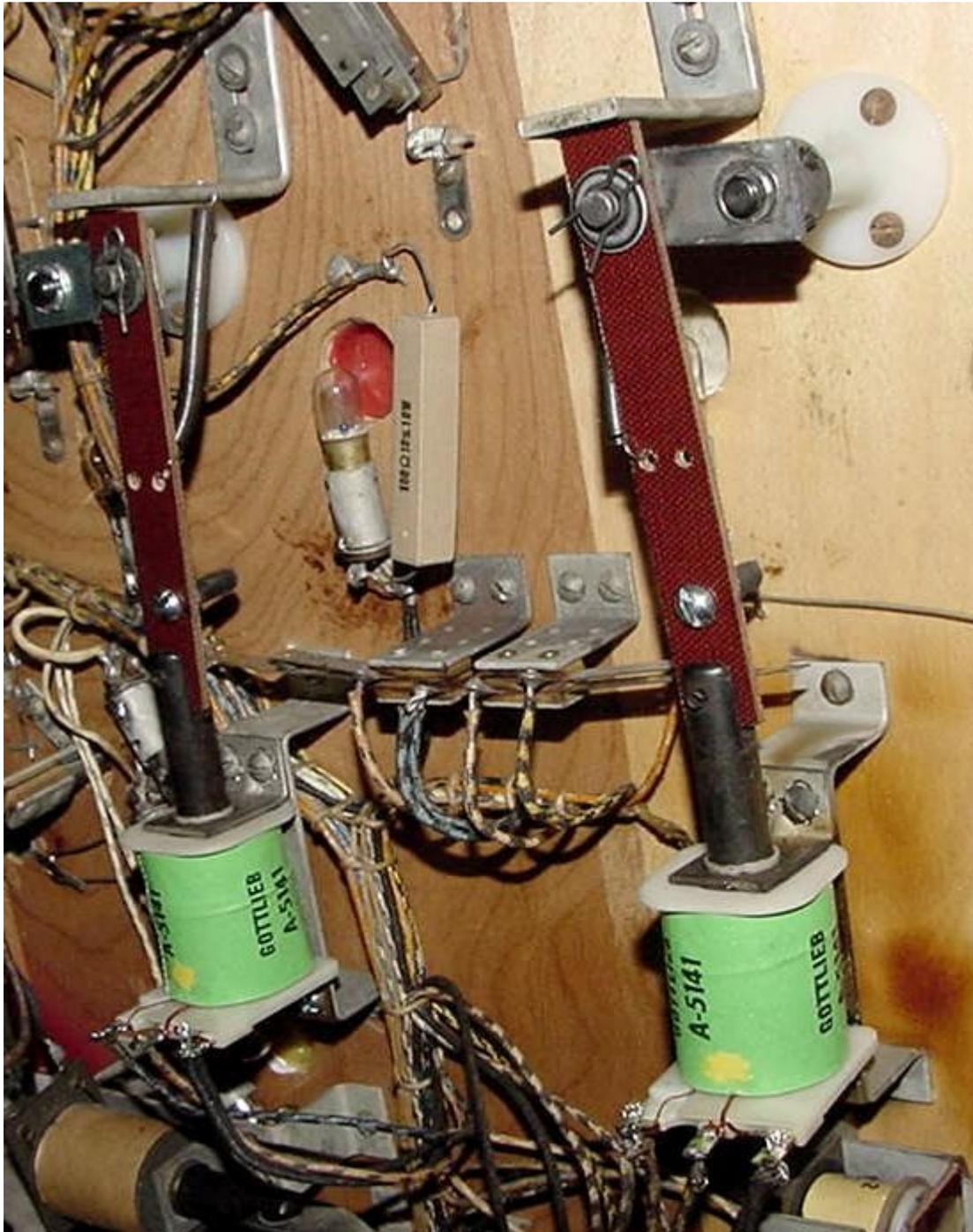
*Reconstruyendo el flipper con un núcleo y biela nuevos, en una Gottlieb de 1960. Se quitó el tope de la bobina o pasador en forma de "C" para liberar las piezas.*
