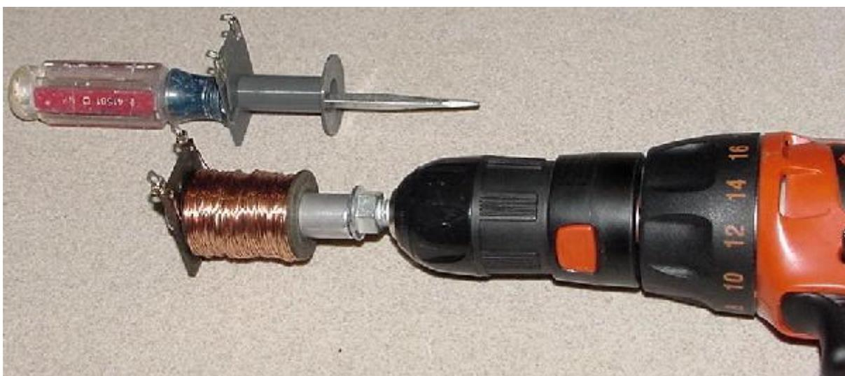
Finalmente basta con lijar los extremos del cable recién trasplantado (para eliminar el esmalte protector) y envolver/soldar el cable en los terminales del carrete. Tu bobina "nueva" está lista para usar.
