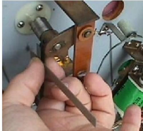
Para limpiar (limar) los contactos de los interruptores puedes usar una lija laminada llamada "FLEXSTONE", alguna lima pequeña, o papel de lija doblado en tiras y de grano 400. No uses limas de uñas; son demasiado bastas y dejan restos entre los contactos de los interruptores; esto puede causar que no hagan buen contacto.
