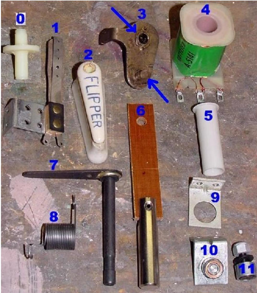
0. Cojinete de nylon para el eje del flipper (flipper bushing)
