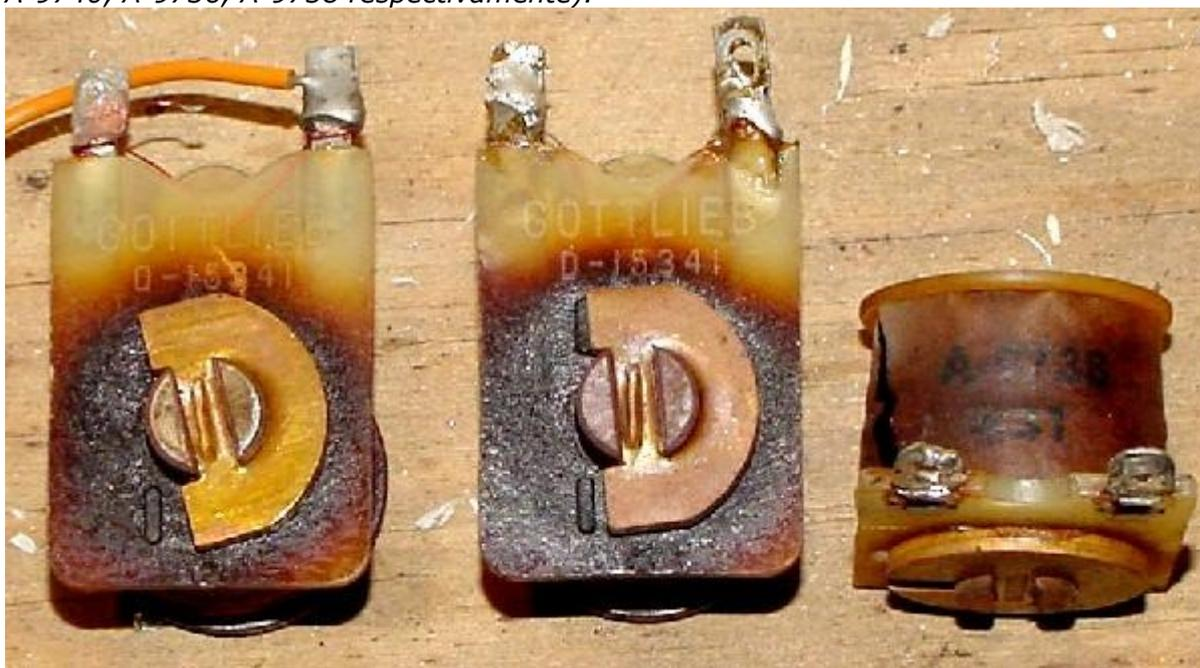
*Este es un relé "Q" de Fin de Partida original, que pertenece a una Fastdraw de Gottlieb. Observa lo quemado que está. Coge demasiada temperatura debido a que la bobina sólo tiene 30 ohmios y está energizada de forma continua.*
