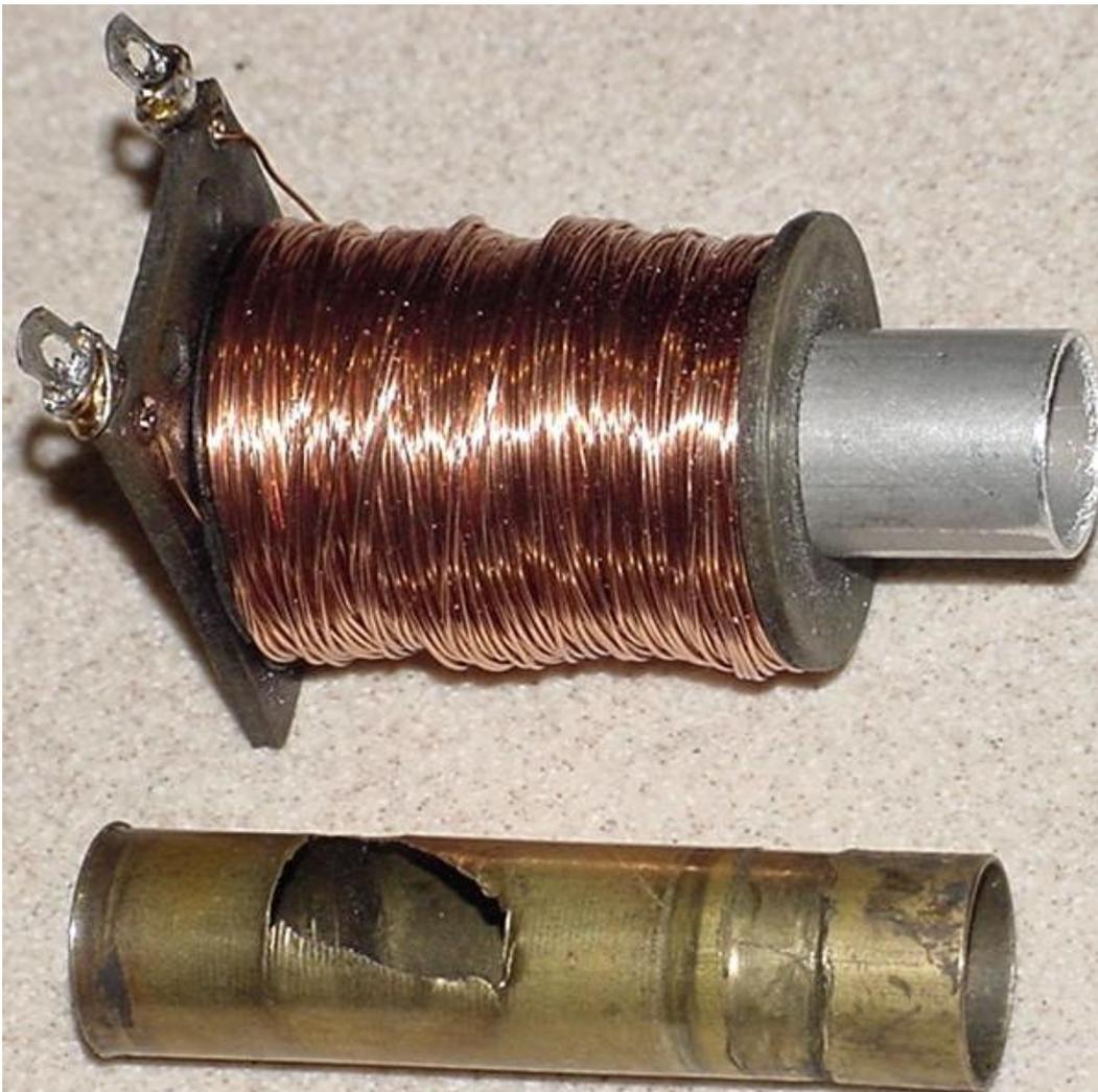
Asumiendo que el carrete antiguo no esté inservible (Esto no se podría hacer en un carrete o casquillo de nylon fundido), retira el cable quemado de la bobina. Usualmente basta con desliar el cable del carrete. Examina entonces el carrete. Si no tiene agujeros, se puede volver a utilizar.
