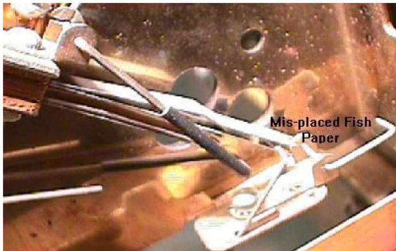
Para asegurarse de no recibir un calambrazo, un buen consejo es cambiar la lámina aislante en el botón de inicio y comprobar las láminas en los interruptores de los monederos.
