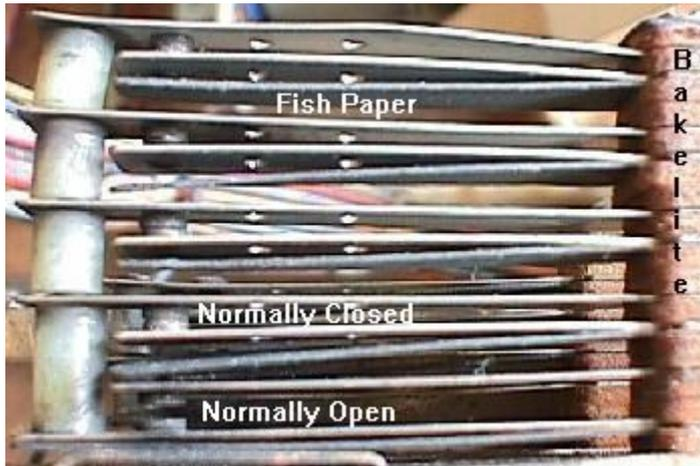
**Normalmente Abierto** (Normally Open) significa que el contacto parte de la situación de abierto (láminas separadas). Al activar el interruptor, se juntan las láminas y el contacto se cierra dejando pasar la corriente. Gottlieb identifica estos contactos como tipo "A".
