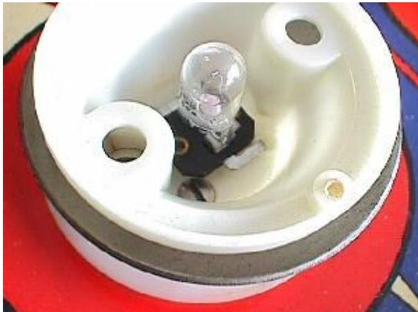
Desde la parte superior del tablero, sacamos la tapa del bumper. Normalmente está sujeta en su sitio con dos pequeños tornillos (aunque en ocasiones entra simplemente a presión). Después hay que sacar la bombilla para acceder a dos tornillos que sujetan el cuerpo del bumper al tablero (próximo al portalámparas). Hay que sacar esos dos tornillos.
