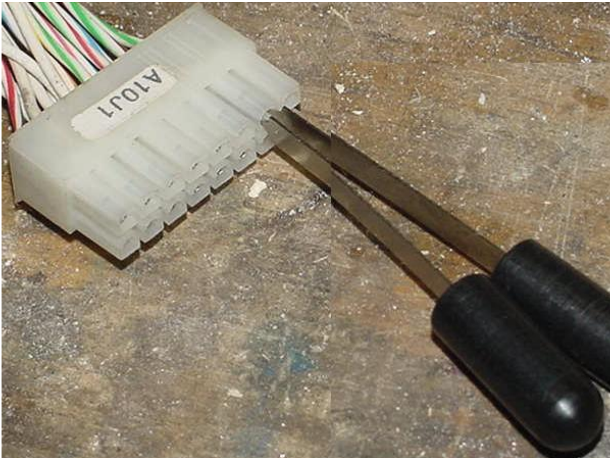
El pin extraído de la carcasa y las dos herramientas Molex..
