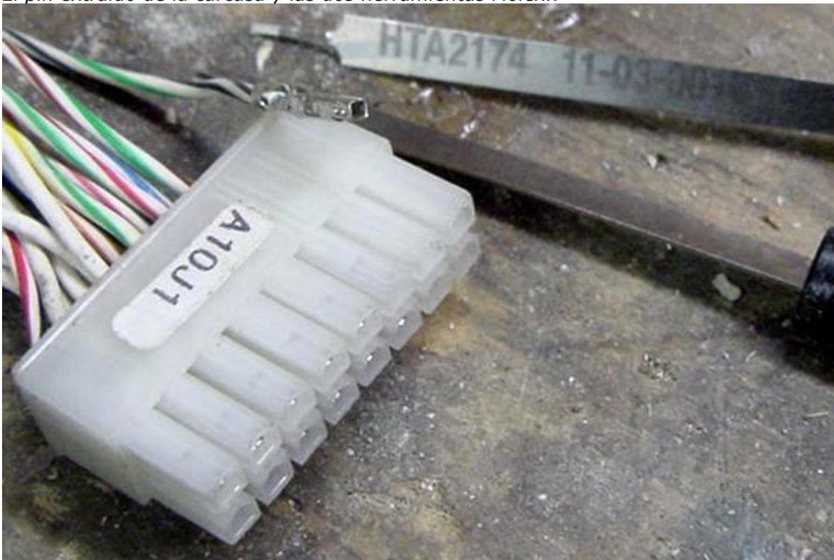
El pin extraído de la carcasa y las dos herramientas Molex..
